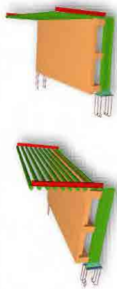
Figura 77: Modelo 3D plataforma en voladizo.
