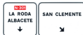
S-360 Señales sobre la calzada, en carretera convencional. Salida inmediata hacia carretera convencional y dirección propia
