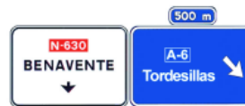
S-232a Preseñalización con señales sobre la calzada en carretera convencional hacia autopista o autovía y dirección propia
