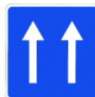
S-11a Calzada de sentido único
