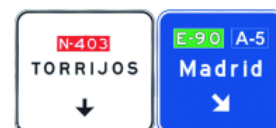
S-362 Señales sobre la calzada, en carretera convencional. Salida inmediata hacia autopista o autovía y dirección propia
