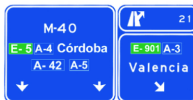
S-368 Señales sobre la calzada, en autopista o autovía. Salida hacia autopista o autovía y dirección propia
