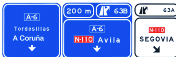
S-373 Señales sobre la calzada en autopista o autovía. Dos salidas inmediatas muy próximas hacia carretera convencional y dirección propia
