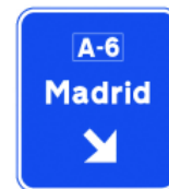
S-354 Señal sobre la calzada, en carretera convencional. Salida inmediata hacia autopista o autovía
