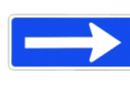
S-12 Tramo de calzada de sentido único
