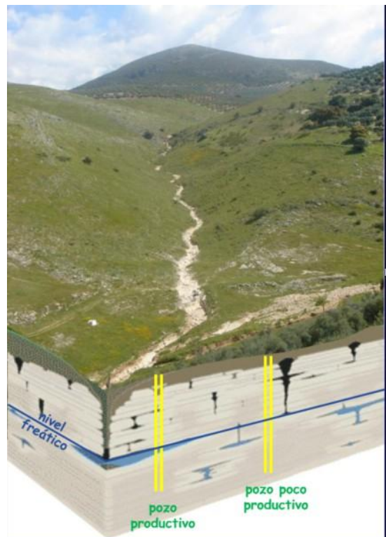
Figura 12. Esquema que explica la diferente productividad que presentan los pozos en los acuíferos kársticos.
