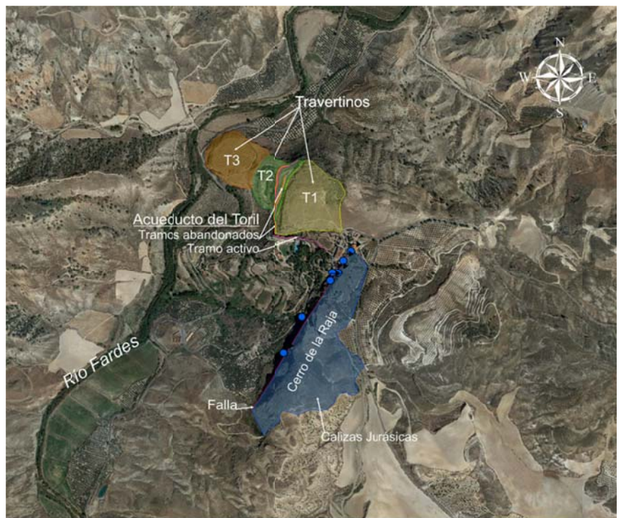
Figura 10. Afloramiento de carbonatos jurásicos del Cerro de la Raja, surgencias de aguas termales asociadas, plataformas de travertinos y Acequia del Toril.
