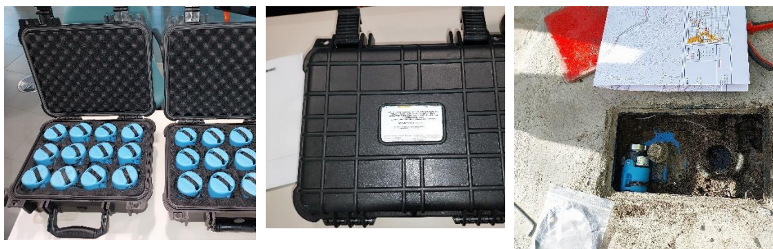
Prelocalizadores y ejemplo de colocación.
