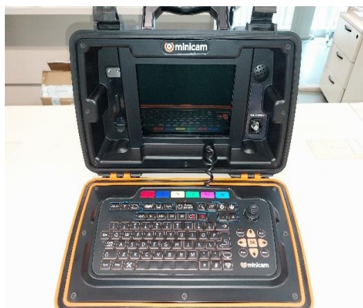
Instrumentación para la inspección de redes de saneamiento.
