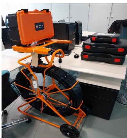
Instrumentación para la inspección de redes de saneamiento.
