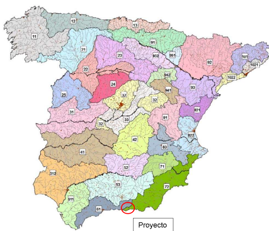
Ilustración 4. Regiones consideradas para la caracterización del Coeficiente Corrector del Umbral de Escorrentía. Figura 2.9 de la Norma 5.2. – I.C.
