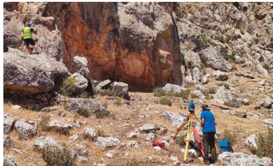
Fig 2. Establecimiento de posiciones georreferenciadas para la ubicación de ortofotografía y fotogrametría del abrigo.
