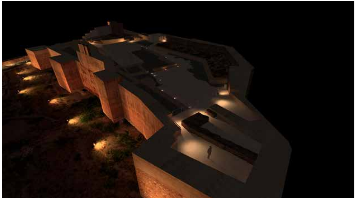
Fig. 4 Iluminación del punto de interpretación en la Torre del Homenaje. (Imagen realizada con el programa de cálculo Dialux Evo)
