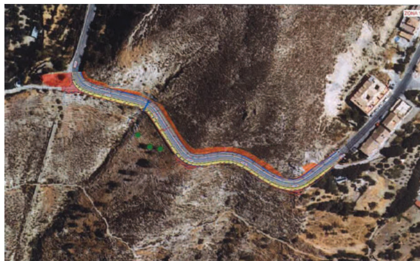
Figura Nº 3.- Planta de los desmontes proyectados.
