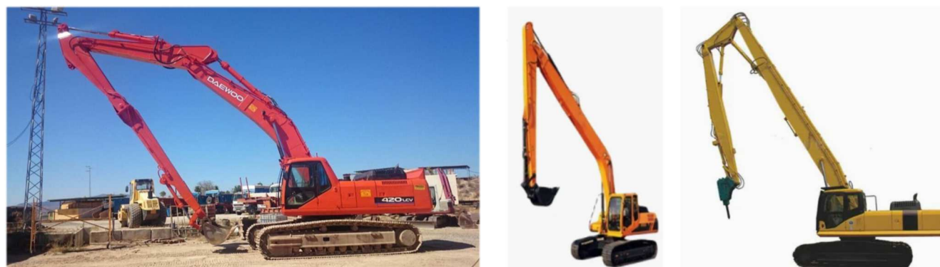
Ejemplos de excavadoras giratorias con brazo de gran alcance de corte vertical.
