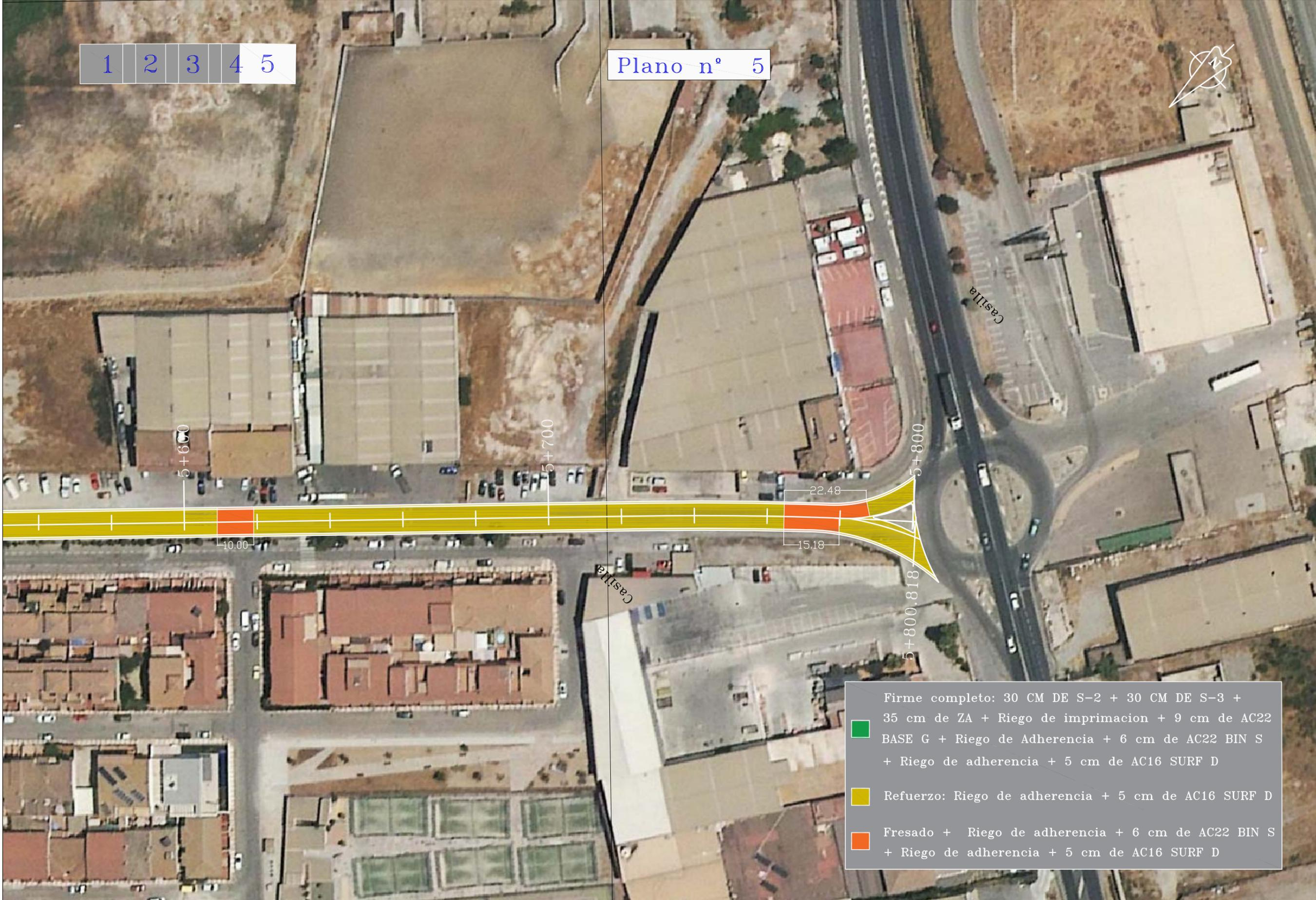
Firme completo: 30 CM DE S-2 + 30 CM DE S-3 + 35 cm de ZA + Riego de imprimacion + 9 cm de AC22 BASE G + Riego de Adherencia + 6 cm de AC22 BIN S + Riego de adherencia + 5 cm de AC16 SURF D
