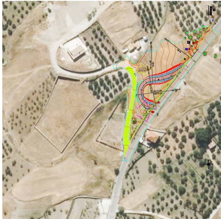
Figura Nº 4.- Superposición de plano topográfico del vial sobre el que se realizará el ramal de giro.
